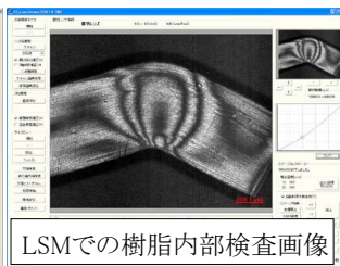
加工済水晶外観欠陥検査をLSMで寸法検査可能です
